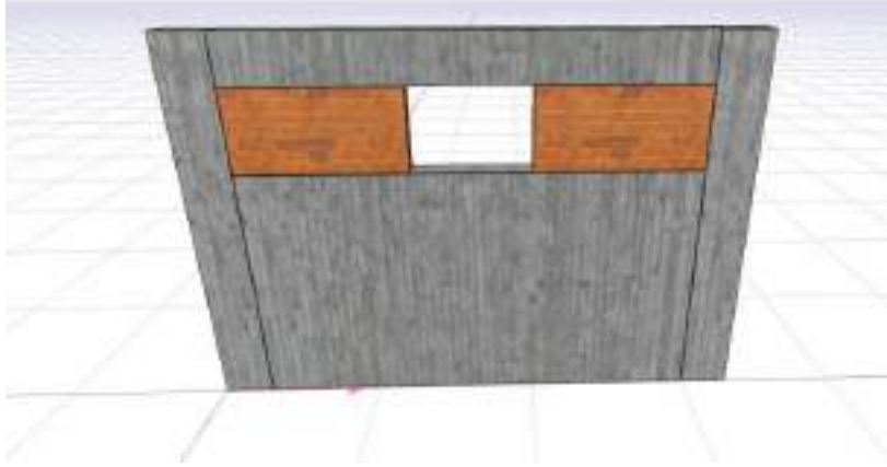
Şekil 10. Bant pencere arasına duvar örülmelidir.
