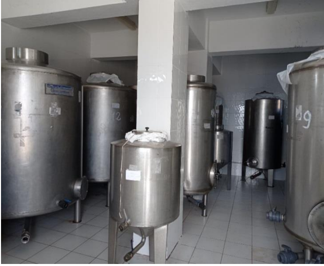
Resim 3. G1 Kodlu Katılımcının Üretim Tesisindeki Paslanmaz Çelik Fermantasyon Tankları
